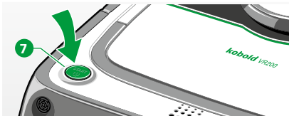
Billede 3.2 Tænd robotstøvsuger
