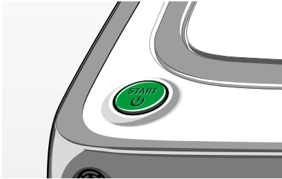
Billede 3.17 Tryk på robotstøvsugerens start-/stopknop for Standby-funktion
